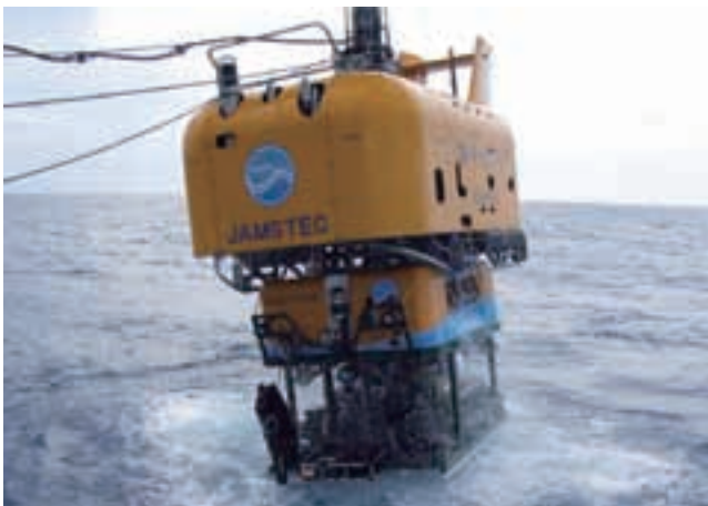
無人探査機「かいこう7000 II」、世界トップクラスの7,000mまで潜航可能です。
