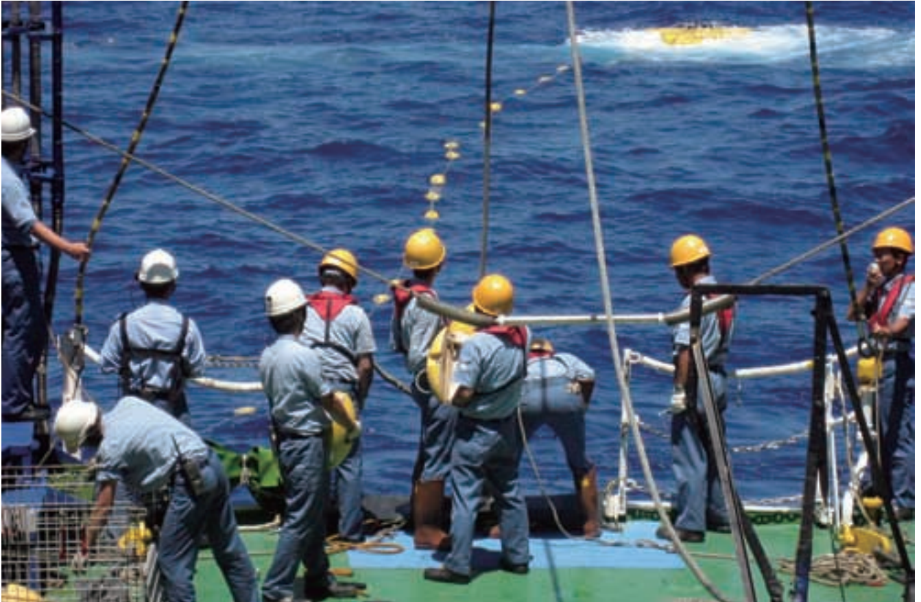
ハイバードルフィンの着水作業を行う甲板部。
