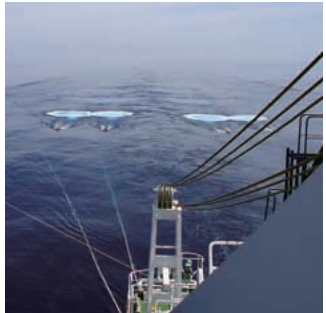
深海調査研究船「かいいい」がえい航する新MCSシステムのエアガンが、海底下深くまで伝搬する地震波を発生させます。
