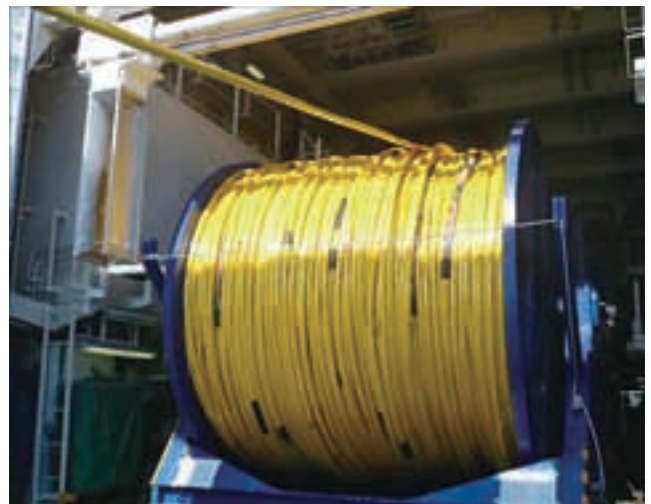
ストリーマケーブルの長さは全長6,000m。その中に444個の受信機が装着されています。
